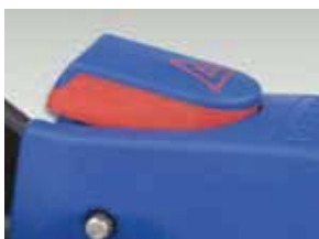
Vakuum zu niedrig
